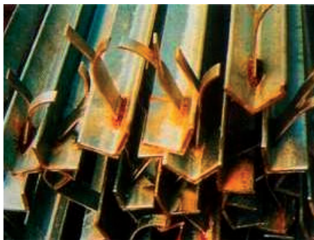
Abb. 18: Fehlstellen im Zinküberzug durch nicht entfernte Schweiss-schlacken
